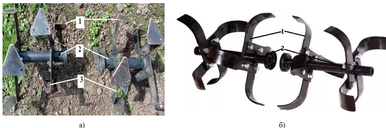
Рис. 5. Фрезы для малогабаритной почвообрабатывающей техники: а – сегментная, б – саблевидная: 1 – ножи фрезы (сегментные, саблевидные); 2 – оси фрезы; 3 – стойка фрезы / Fig. 5. Milling cutters for small-sized tillage equipment: a – segmented, b – saber-shaped: 1 – milling cutter knives (segmented, saber-shaped); 2 – milling cutter axes; 3 – milling cutter rack
