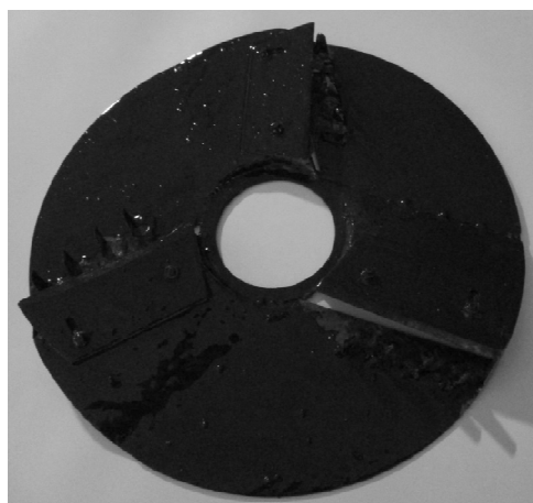
Рис. 5. Режущий диск измельчителя корнеклубнеплодов с тремя горизонтальными ножами
