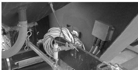
Рис. 5. Общий вид датчика вращения вала дозатора ДВр-1 и блока сбора данных (БСД)
