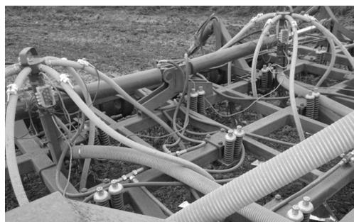
Рис. 3. Общий вид датчиков высева семян (ДВ), закрепленных на семяпроводах, и распределительных коробок (РК), установленных на вторичных распределителях
